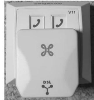
Das VDSL-Modem muss mit einem geeigneten Verbindungskabel an die RJ11-Buchse des steckbaren Splitters oder der VoIP-Buchse angeschlossen werden.
