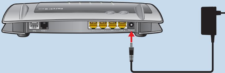
3. Stecken Sie das Netzteil in eine Steckdose der Stromversorgung. Die Leuchtdiode „Power / DSL“ beginnt nach einigen Sekunden zu blinken und signalisiert damit die Betriebsbereitschaft der FRITZ!Box.
